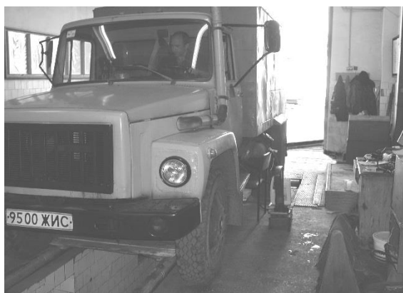
Рисунок 1 – Експериментальні дослідження витрат біопалив автомобілем ГАЗ-33060 на стенді з біговими барабанами
