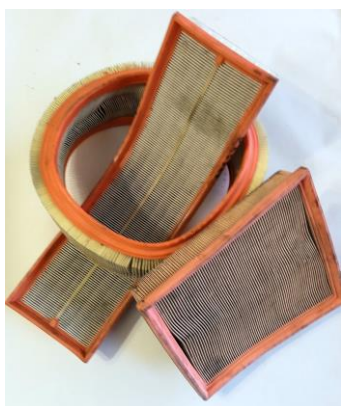
Рисунок 1 – Фото відпрацьованих повітряних фільтрів
