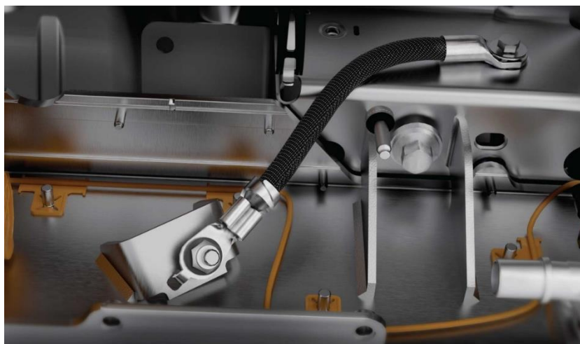
Рисунок 2 – Шина системи вирівнювання потенціалів, що з'єднує високовольтну батарею з кузовом автомобіля
