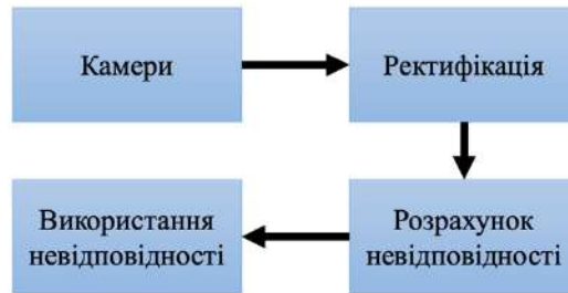
Рис. 1. Узагальнена схема програмно-апаратного засобу побудови апаратної архітектури для систем комп'ютерного зору на основі FPGA. Типова система стереозору
