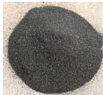
Рис. 2. Порошок бронзи марки ПР-БРАЖ 9.5-1
