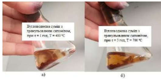
Рис. 1. Фото суспензій природного гранульованого сапоніту у вуглеводневих сумішах: а) при \tau=1 год, T=400 °C; б) при \tau=3 год, T=700 °C
