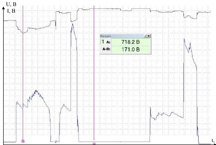
Рис. 3. Приклад осцилограми зміни навантаження та випрямленої напруги ТП
