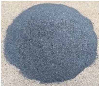
Рис. 3. Порошок нержавіючої сталі PP-12X18H10T
