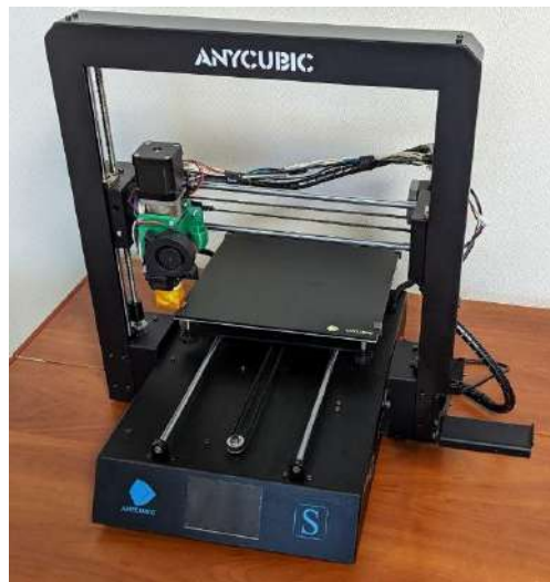
Рис. 9. Загальний вигляд 3D принтера Anycubic Mega S із встановленим екструдером для друку сумішшю композиційного матеріалу
