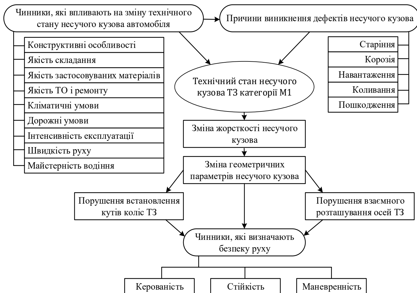
Рисунок 1 – Взаємозв'язок технічного стану несучого кузова з експлуатаційними властивостями автомобіля, які впливають на безпеку руху
