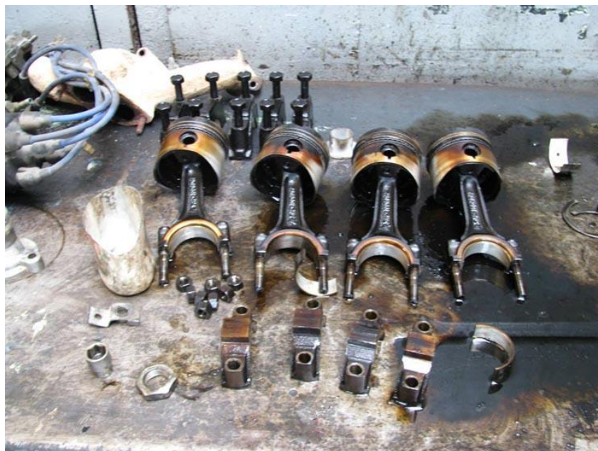
Рис. 3. Деталі з автомобільного двигуна, що зазнавали зношення (фото з кафедрального архіву)
