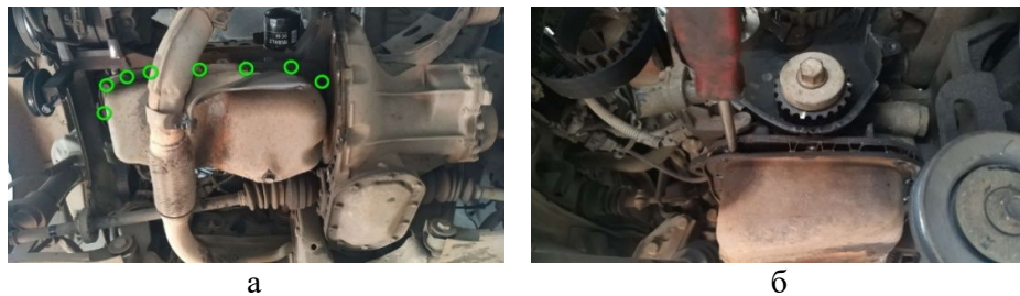
Рис. 5. Відкручення болтів кріплення піддону по колу (позначено зеленим кольором) (а). Знімання піддону (б).
