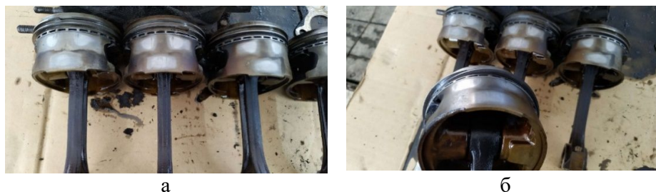
Рис. 8. Огляд стану поршнів і шатунів (а). Перевірка люфту поршневого пальця і вимірювання зазорів в канавці поршневого кільця (б)
