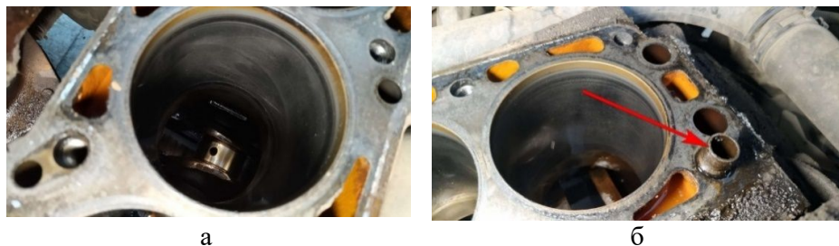
Рис. 7. Візуальний огляд стану шийок коленвала і стан циліндрів (а). Витягування напрямних головок блоку (б)
