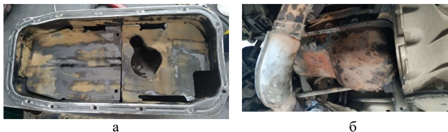
Рис. 11. Очищення від старого герметика піддону і посадкового місця на блоці циліндрів (а). Затягуються всі кріпильних болтів (б)
