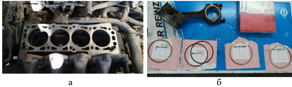
Рис. 9. Видування бруду із різьбових отворів (а). Встановлення на поршні нових кілець
