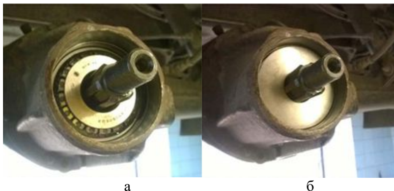
Рис. 7. Втулка, підшипник (а), шайба та встановлений сальник на герметику (на фото його закриває шайба) (б)
