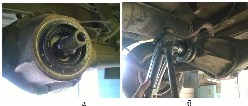
Рис. 8. Майже відремонтований вузол автомобіля (втулка, підшипник, шайба та сальник на герметик) (а). Затягування гайки хвостовика (б)
