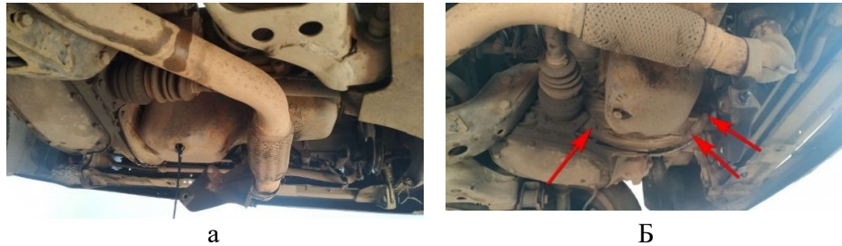
Рис. 4. Відкручування пробки (а). Знімання захисту маховика (б).
