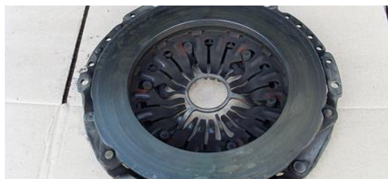
Рис. 5. Зношена поверхня на диску автомобільного зчеплення, що вже зазнав експлуатації (Загальний вигляд) [13]
