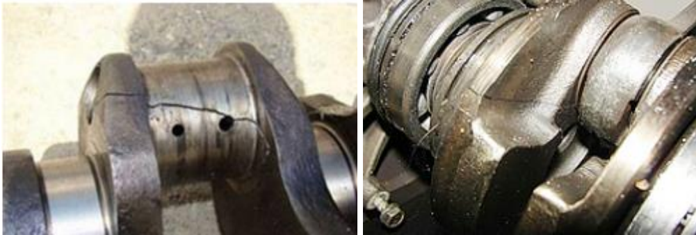
Рис. 2. Тріщини в валах
