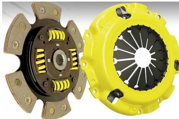
Рис. 3. Дизайнерське спортивне зчеплення з накладками [4]
