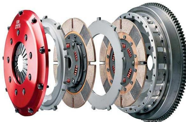
Рис. 2. Дизайнерське бачення зчеплення разом зі фрикційними накладками [5]
