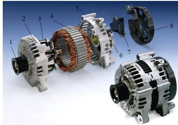
Рис. 1. Генератор змінного струму: 1 – шків; 2 – передня кришка; 3 – ротор; 4 – статор; 5 – задня кришка; 6 – випрямний блок; 7 – регулятор напруги із щіткотримачем; 8 – кожух [2]
