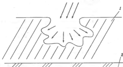
Рис. 2. Схема дії мийного розчину на забруднення: 1 – бруд; 2 – поверхня
