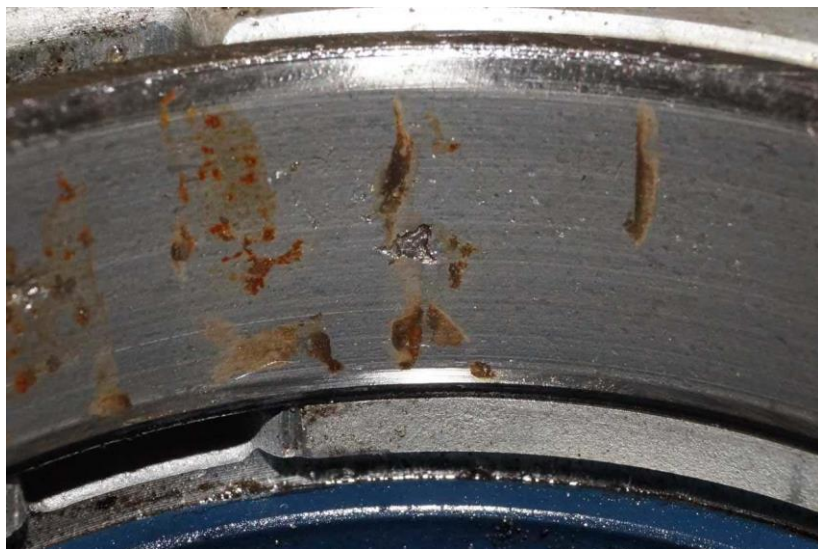
Рис. 1.4.6. Викришування металу на поверхні кочення кільця підшипника.
