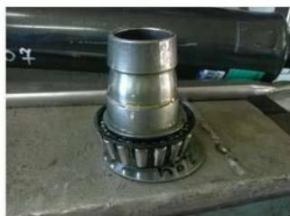
Рис. 1. Автомобільні деталі, що підлягали ремонтним роботам: втулка, підшипник, шайба (а); хвостовик (б)
