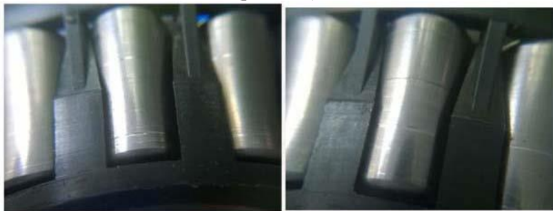
Рис. 4. Подряпини на роликах (а); Знятий підшипник (б)
