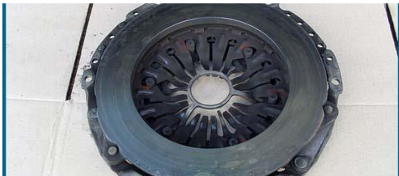
Рис. 3. Зношена поверхня на диску автомобільного зчеплення (Загальний вигляд).
