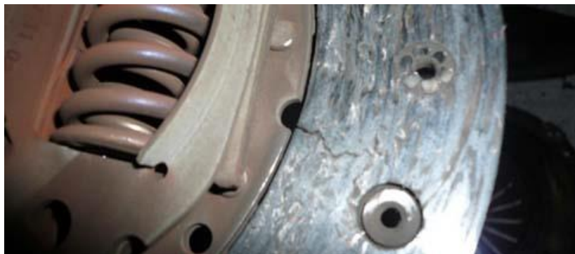
Рис. 2. Зношена поверхня на диску автомобільного зчеплення.
