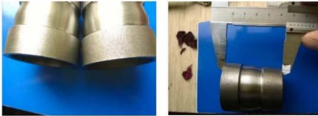
Рис. 6. Зліва – після вібрації, праворуч – нормальний знос (а); Розпірна втулка під час вимірювання (б)
