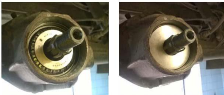
Рис. 7. Втулка, підшипник (а), шайба та встановлений сальник на герметику (на фото його закриває шайба) (б)
