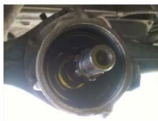
Рис. 1. Автомобільні деталі, що підлягали ремонтним роботам: втулка, підшипник, шайба (а); хвостовик (б)
