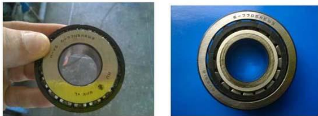
Рис. 3. Підшипник 6-7705АЕШЗ. (а); Знятий підшипник (б)
