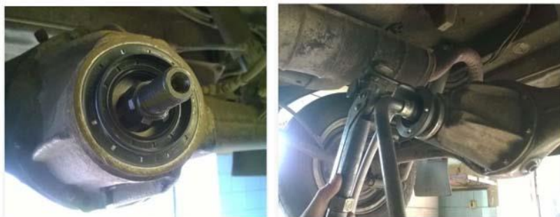
Рис. 8. Майже відремонтований вузол автомобіля (втулка, підшипник, шайба та сальник на герметик) (а). Затягування гайки хвостовика (б)
