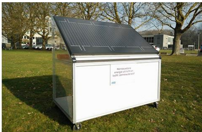
Рис. 10. Сонячна панель розщеплює воду для виробництва водню [22].
