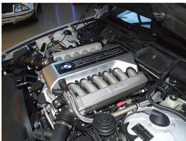
Рис. 31. 12-циліндровий двигун BMW Hydrogen 7 об'ємом 6 літрів [16].
