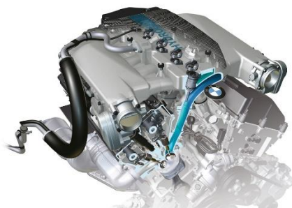
Рис. 32. Шестилітровий 12-циліндровий V-подібний двигун автомобіля BMW H2R, адаптований під живлення воднем.
