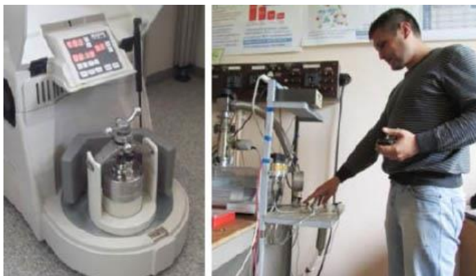
Рис. 20. Обладнання для механохімічного синтезу гідридних композитів та дослідження їх воденьсорбційних властивостей [35, 36].
