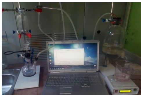
Рис. 22. Дослідна установка для дослідження процесів генерування водню шляхом гідролізу (ФМІ НАН України) [35, 36].
