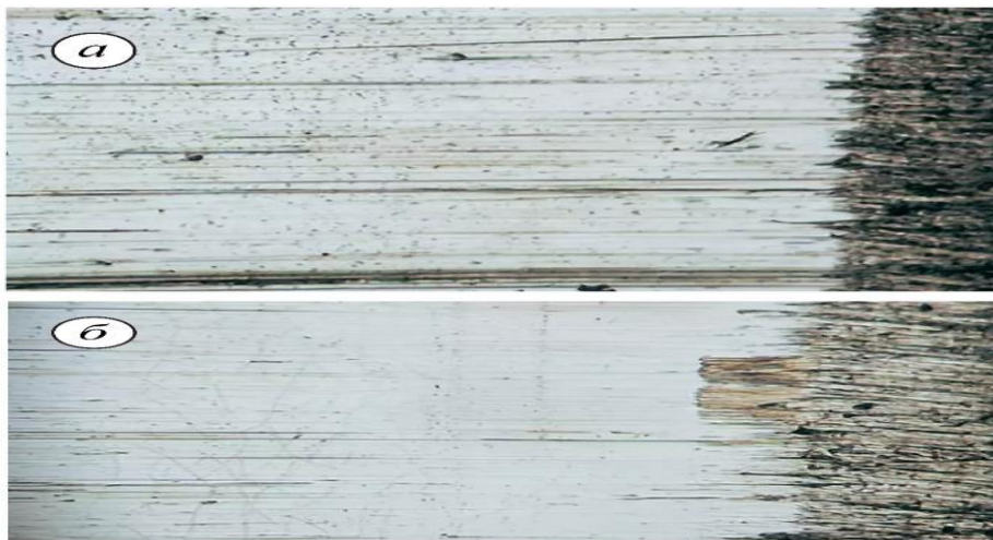
Рисунок 1 – Поверхня першого поршневого кільця автомобільного мотора до обробки (збільшення в 64 рази) – (а). Поверхня першого поршневого кільця автомобільного мотора після того, як після того, як двигун пройшов повну обробку препаратом на базі ГМТ– (б) [10]
