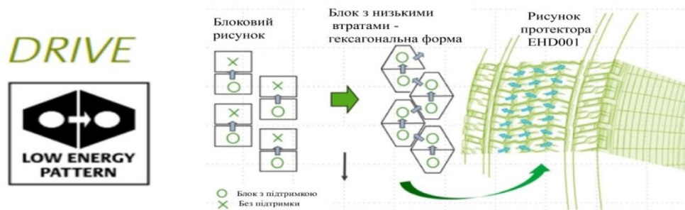
Рисунок 5 – Спеціально розроблений дизайн блоків протектора оптимізує їх деформацію при русі, що дозволяє істотно знизити втрату енергії без зниження тягових характеристик і ресурсу шини [6]
