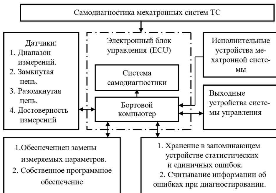
Рисунок 2. Структурная схема самодиагностики мехатронных систем ТС
