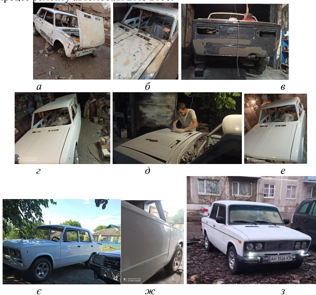
Рис. 1. Кузовні роботи з видалення корозії на ВАЗ 2106 (а). Шпаклювання елементів кузова ВАЗ 2106 (б, в). Грунтування ВАЗ 2106 (г). Замивання ґрунту на ВАЗ 2106 (д). Повне фарбування кузова ВАЗ 2106 (е, є). Полірування кузова ВАЗ 2106 (ж). Готовий результат після ремонту автомобіля ВАЗ 2106 (з)
