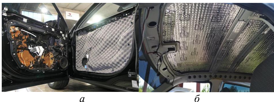
Рис. 1. Приклад шумоізоляції в автомобілі: дверей (а), даху (б)
