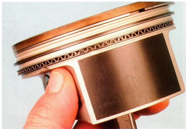
Рис. 1. Тонкий шар антифрикційного покриття (темного кольору) на спідниці поршня допомагає утримувати масло і знижує тертя між поршнем і циліндром - особливо при холодному запуску двигуна [5]
