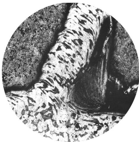
Рис.2.4. Микрофотография «корня» стружки (Б.М. Орлов)
