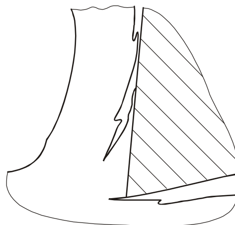
Рис.2.24. Схема образования нароста
