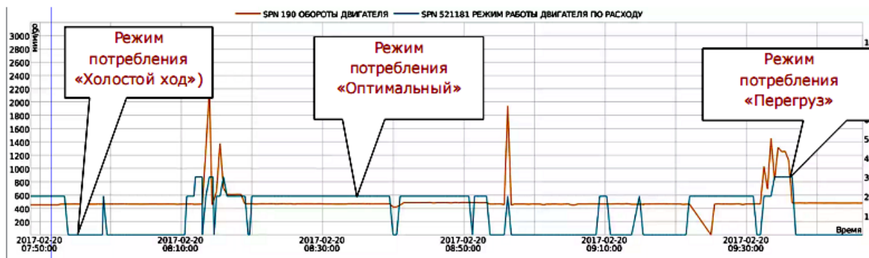
Рисунок 2 - Контроль расхода топлива ТС в различных режимах потребления
