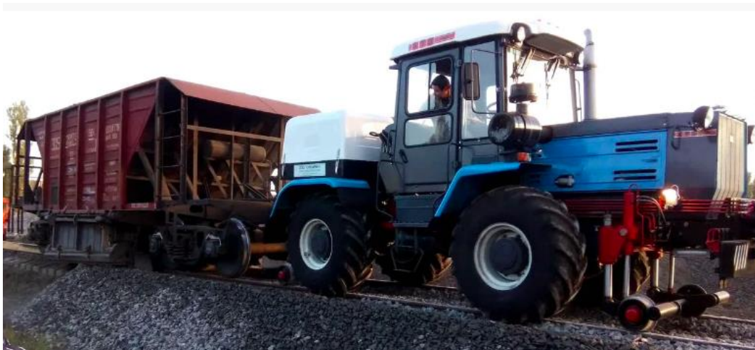
Рисунок 1 – Локомотив ММТ-2М на базі трактора ХТЗ-150К-09-25 [4].
