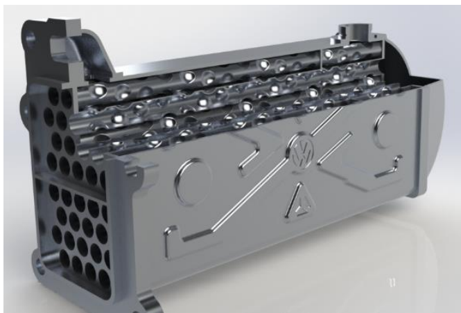
Рис. 1. Комп'ютерна модель теплообмінника EGR в розрізі
