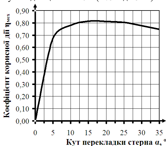
Рис. 1. Графік залежності механічного ККД механізму ГРМ від кута повороту стерна
