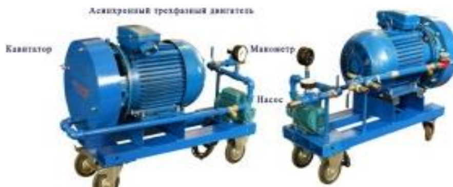
Рис. 2. Тепловая станция мобильная (ТСМ)
