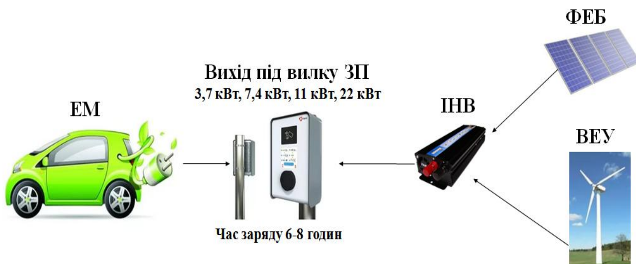
Рис. 4.1. Схема стандартного заряду електромобілів від установок змінного струму на основі відновлюваних джерел енергії: ФЕБ – фотоелектрична батарея; ВЕУ – вітроелектрична установка; ІНВ – інвертор; ЗП – зарядний пристрій; ЕМ – електромобіль.
