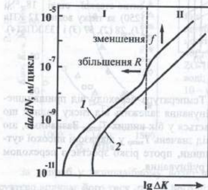
Рис. 5.25. Схема впливу водню на хід КДВР: 1 – водень; 2 – повітря.
