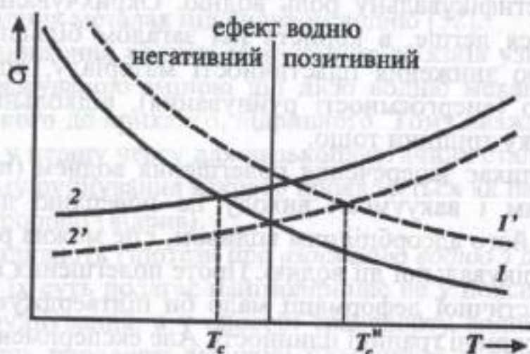
Рис. 5.6. Схема, яка ілюструє зміну механізму руйнування з крихкого до в'язкого з підвищенням температури випроб.
