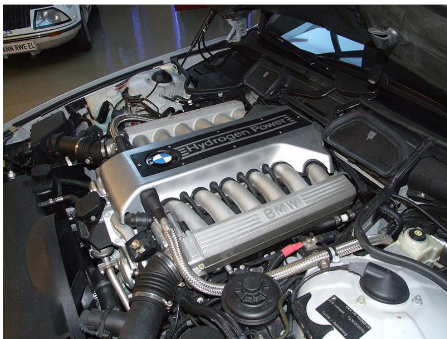
Рисунок 7 – 12-циліндровий двигун BMW Hydrogen 7 об'ємом 6 літрів [58]
