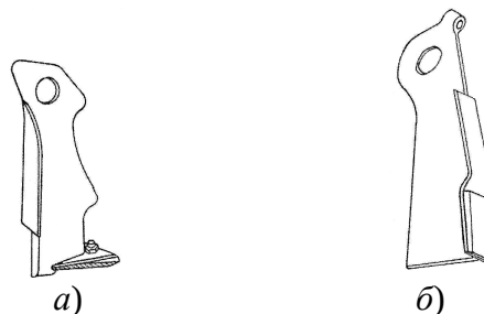
Рис. 3. Варианты конструкций шарнирных ножей:
