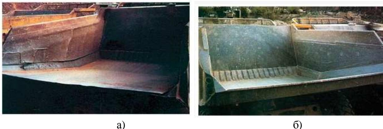
Рис. 1. Кузова самосвалов, которые находились в работе одинаковое время. Кузов из стали с твердостью 270 HB (а), кузов из стали HARDOX® 400 (б)
