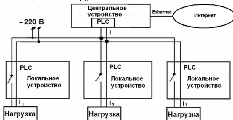
Рис 1. Система управления, мониторинга и защиты электросети
