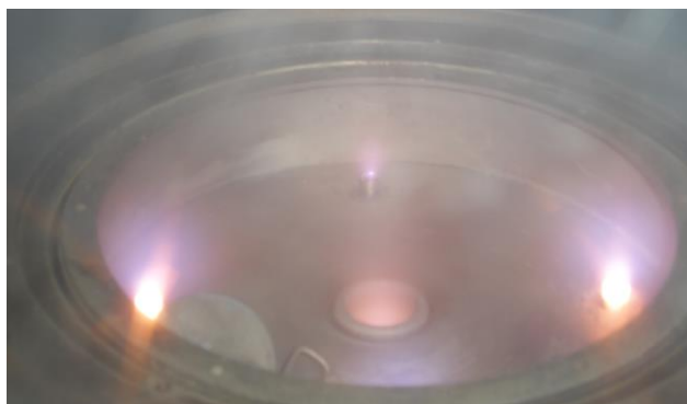
рис 4 Плазменный испаритель со стороны смотрового окна
