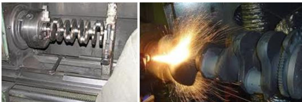
Рисунок 2 – Ремонт колінчастого вала
