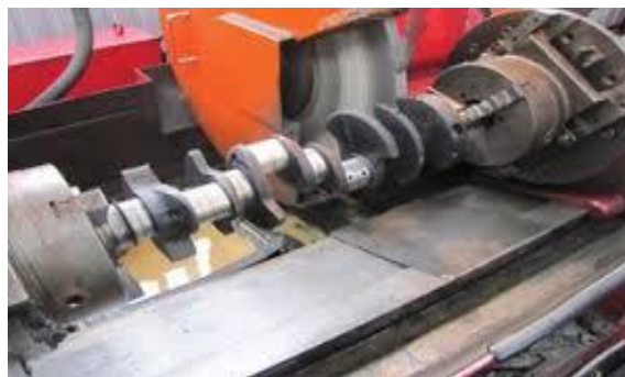
Рисунок 3 – Ремонт колінчастого вала
