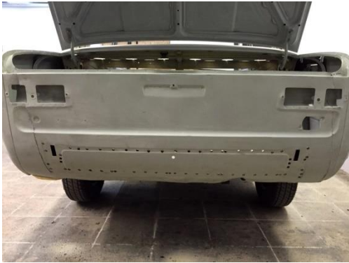
Рисунок 13 – Для початку висвердлюється точкове зварювання в районі кріплення лонжеронів - а. Свердління по периметру – б
