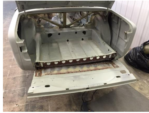
Рисунок 13 – Для початку висвердлюється точкове зварювання в районі кріплення лонжеронів - а. Свердління по периметру – б
