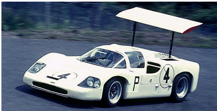
Рисунок 2 – Один із перших гоночних автомобілів, на котрому було встановлено велике антикрило, змонтоване на тонких стійках для збільшення притискної сили (Chaparral 2F 1967р.)
