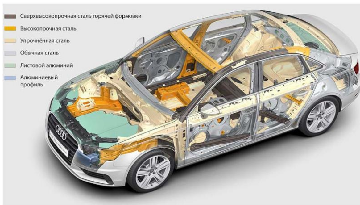
Рисунок 1 – Пример использования различных сталей и сплавов для изготовления кузовных деталей [17]
