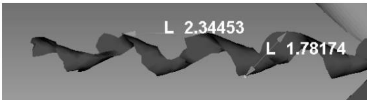
Рисунок 10 – Вид і геометричні параметри стружки на 15470 кроці [17]
