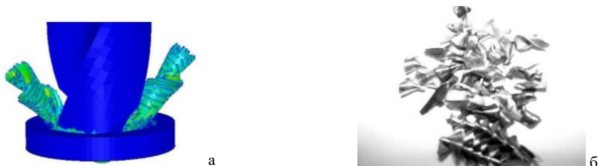
Рисунок 8 – Прогнозована форма стружки [14]
