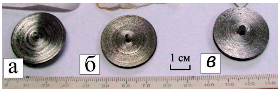
Рис. 5 – Зразки після точіння в: а – ЗОР, б – воді, в – на сухо
