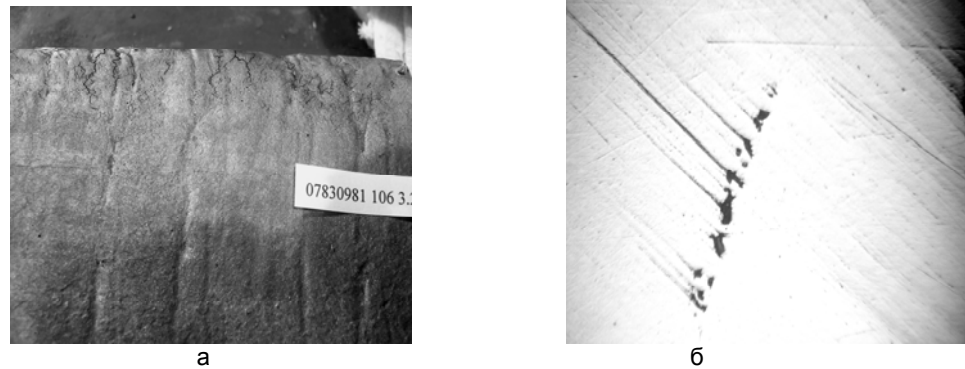
Рис. 2. Грубые следы качания с трещинами - а и микроструктура подповерхностной зоны с неметаллическими включениями - б, x100
