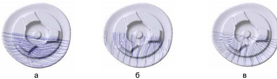
Рис.4. Оценка внутреннего течения металла
