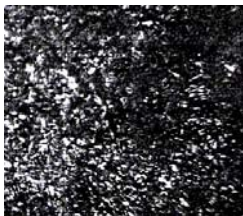
Рис. 4. Микроструктура зуба шестерни стали 45ХН (С - 0,43%; Мп - 0,71%; Сг - 0,64%; Ni - 1,1%) после ТВЧ закалки: 1 - структура поверхностного закаленного слоя зуба (HRC=49-50); 2 – структура сердцевины зуба (HB=302), (x200)
