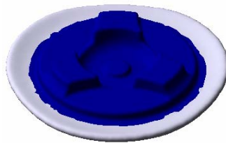
Рис.4. Модель заполнения гравюры штампа
