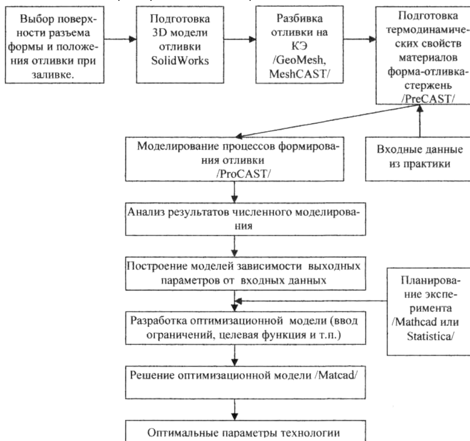
Рис. 1. Компьютерное проектирование технологии литья
