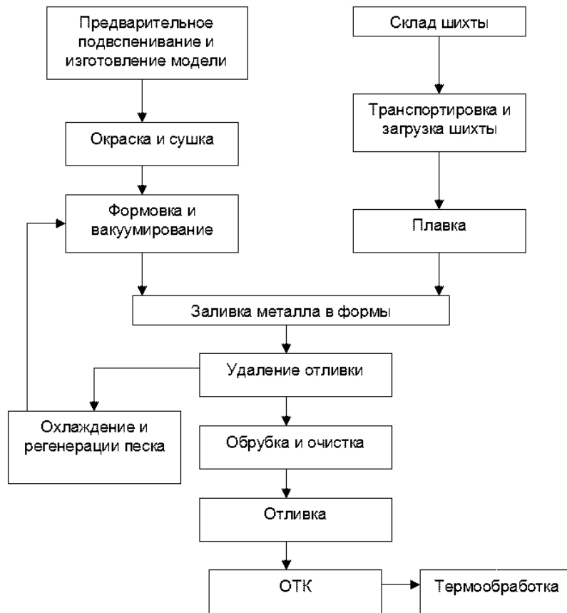
Рис. 2 Схема изготовления отливок по ГМ
