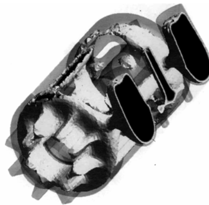
Рис. 3. Горизонтальное положение отливки при заливке
