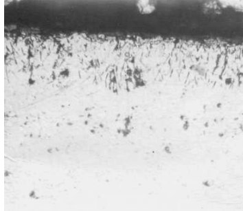
Рис. 1. Микроструктура поверхностного слоя образцов из стали 25Х14Г14С2Ю после насыщения углеродом при температуре 930 °С в течение 1000 часов (нетравленный микрошлиф)
