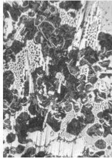
Рис. 1. Микроструктура центробежнолитого валка с 2% ванадия в рабочем слое, x100
